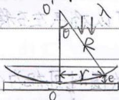
② 干涉现象的产生：用单色平行光（波长为  $\lambda$ ）垂直照射到装置上，入射线会在平凸透镜的下表面和平板玻璃的上表面发生反射。这两束反射光来自同一入射光，满足相干条件，它们在相遇时会发生干涉。
