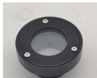
图1 牛顿环装置
