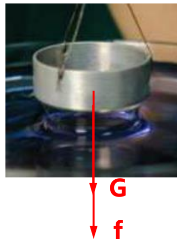
液膜拉破前瞬间的受力分析图
